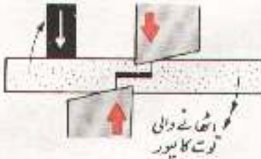
شکل 46.2: کیتیرے پر عمل کرنے والی قوتیں چادور کے ٹکڑے کو الٹانے کی کوشش کرتی ہیں
