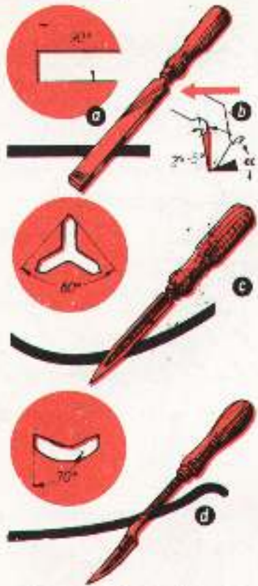
شکل 65.1: ہموار سطحوں کے لیے چھپے پیر (a) کے لیے حرکت کرنے کے دوران کھرجائی کرنے والا (b) پیچھے کی طرف حرکت کے دوران کھرجائی کرنے والا (c) گول سوراخوں کے لیے کھرجا سکر پیر (d) چھجنا سکر پیر
