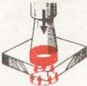
شکل 81.1: کٹائی کے لیے درکار قوت میٹرل کی مزاحمت کٹائی سے زیادہ ہونی چاہیے۔
