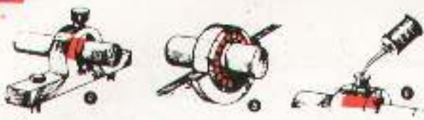
شکل 69.1: بجنہٹ سے غیر مطلوبہ رگڑ کو کم کیا جاتا ہے (a) بڑی سہلپ کے ذریعے رگڑیں دینا (b) بال بڑی رگڑیں لگانا (c) سلائیڈ رگڑ کو تیل دینا۔
