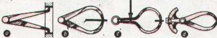
شکل 12.3: (a) اندرونی کیلیپر (b) بیرونی کیلیپر (c) سپرنگ کیلیپر (d) سکیل والا کیلیپر
