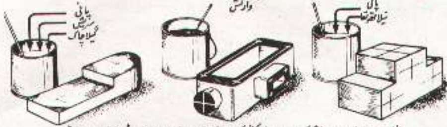
شکل 30.1: مختلف قسم کے جابوں پر خط کشی کے لیے لگائے جانے والے مٹی۔ ٹیل: ڈھالے اور پٹے ہوئے جابوں کے لیے؛ درمیان: مٹی دھاتوں کے لیے؛ دائیں: ٹیل جابوں کے لیے۔
