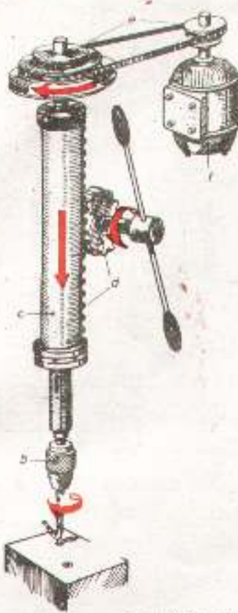
شکل 88.1: ڈرنک مشین کے اجزاء (a) سینڈل (b) پکب (c) سینڈل سلیو (d) گزاری اور رینگ گزاری (e) پیمانہ (f) ڈرنک
