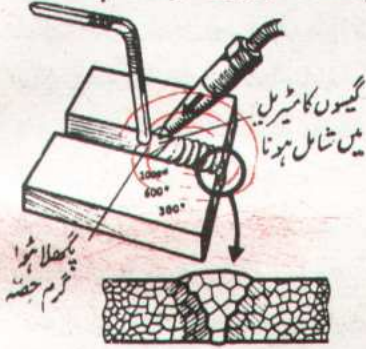
شکل ۱۹۴.۱: جاب کے میٹرل پر ویلڈنگ کا اثر
