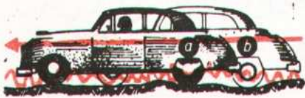
شکل 121.1: کمانوں (سپرنگوں) پر رکھی ہوئی کار کی باڈی، کار کے دھڑکنے جھٹکوں کو برداشت کرتے ہیں اور کار کو جھٹکے نہیں لگتے۔
