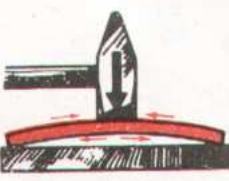
شکل 118,3: ہڈی ہوئی میٹرل کو سیدھا کرنا۔
