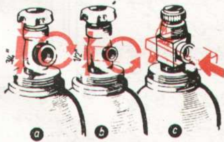
شکل 198.2: پریشر ریگولریٹر کو لگانے کے مختلف طریقے (a) آکسیجن (b) ہائیڈروجن (c) اسیٹیلین
