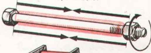
شکل 133,1: چوڑیوں والے پیچ پر نٹ کی حرکت: (a) گردش حرکت خطی حرکت کا باعث بنتی ہے (b) چوڑی کے بل
