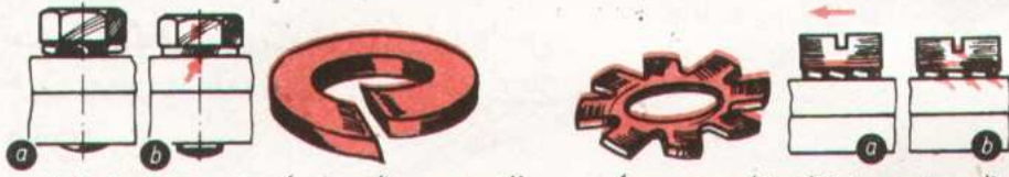
شکل 131.2 سپرنگ واشروں کے استعمال سے پیچ ڈھیلے نہیں ہوتے پاتے (a) پیچ کو کسنے سے پہلے (b) پیچ کو کسنے کے بعد
