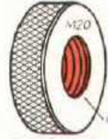
1. B-209, 1 - (روائیں اور اوپر) معیاری تقریبی گیج (thread gauges)۔ 2. معیاری چوڑی رنگ گیج - (b) معیاری پلگ چوڑی گیج
