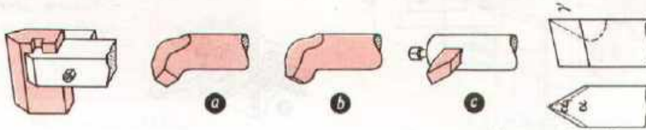
B 195, 1 چوڑی کاٹنے کے ٹول کی شکلیں۔ (a) دھٹ برتنہ چوڑی۔ (b) میٹرک چوڑی۔ (c) اینچی چوڑی۔ (d) ٹریس چوڑی۔ (e) گول چوڑی۔
