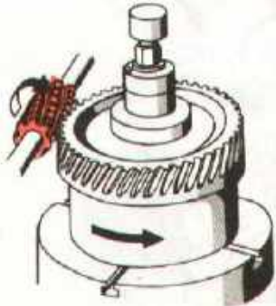
B 216, 3 - ترچھے دندانوں والی گریاں (helical gears) ہابنگ کے طریقے سے کاٹنا۔
